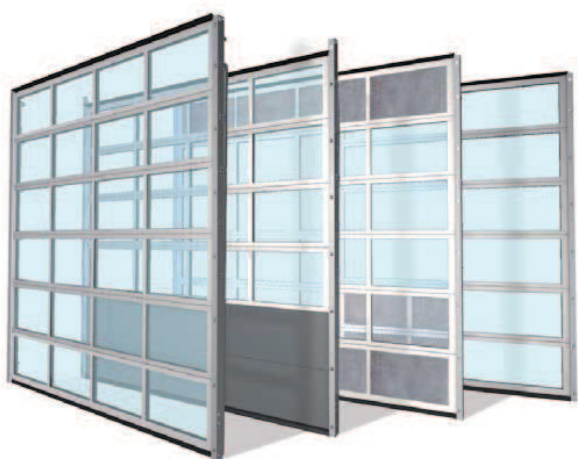
Thermo 60 szekcionált kapu U\text{-érték} = 2,33 \text{ W/m}^2\text{K} (5.000x5.000 mm kapu esetén) 3-rétegű üvegezéssel
