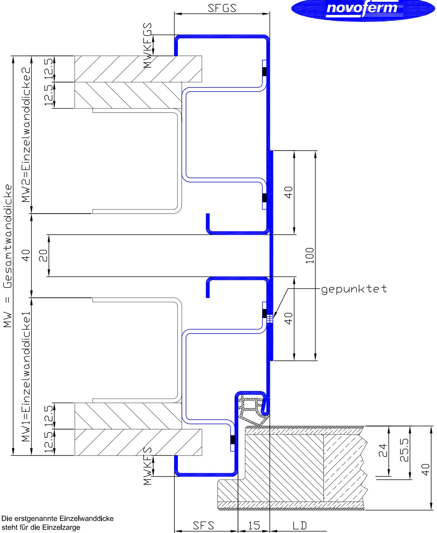
Die erstgenannte Einzelwanddicke steht für die Einzelzarge mit Türfalz (Falzseite)
