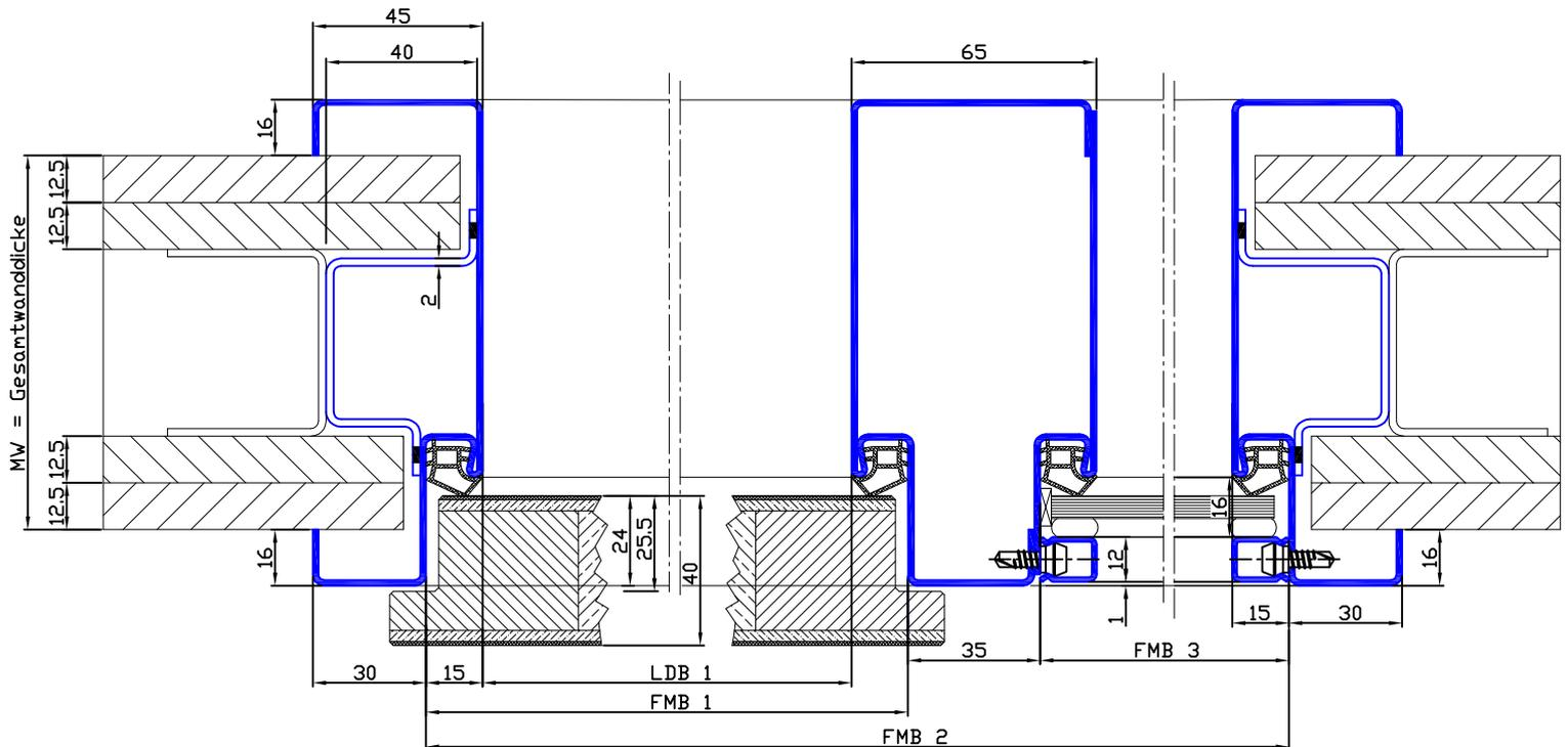
Montage mit selbstschneidenden Schrauben  $\text{\O} 6,3 \text{ mm}$ .
