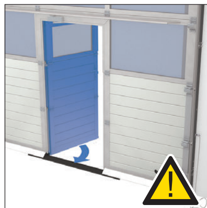
6. A szekcionált kapu nyitása előtt győződjön meg arról, hogy a személybejáró zárva van.
