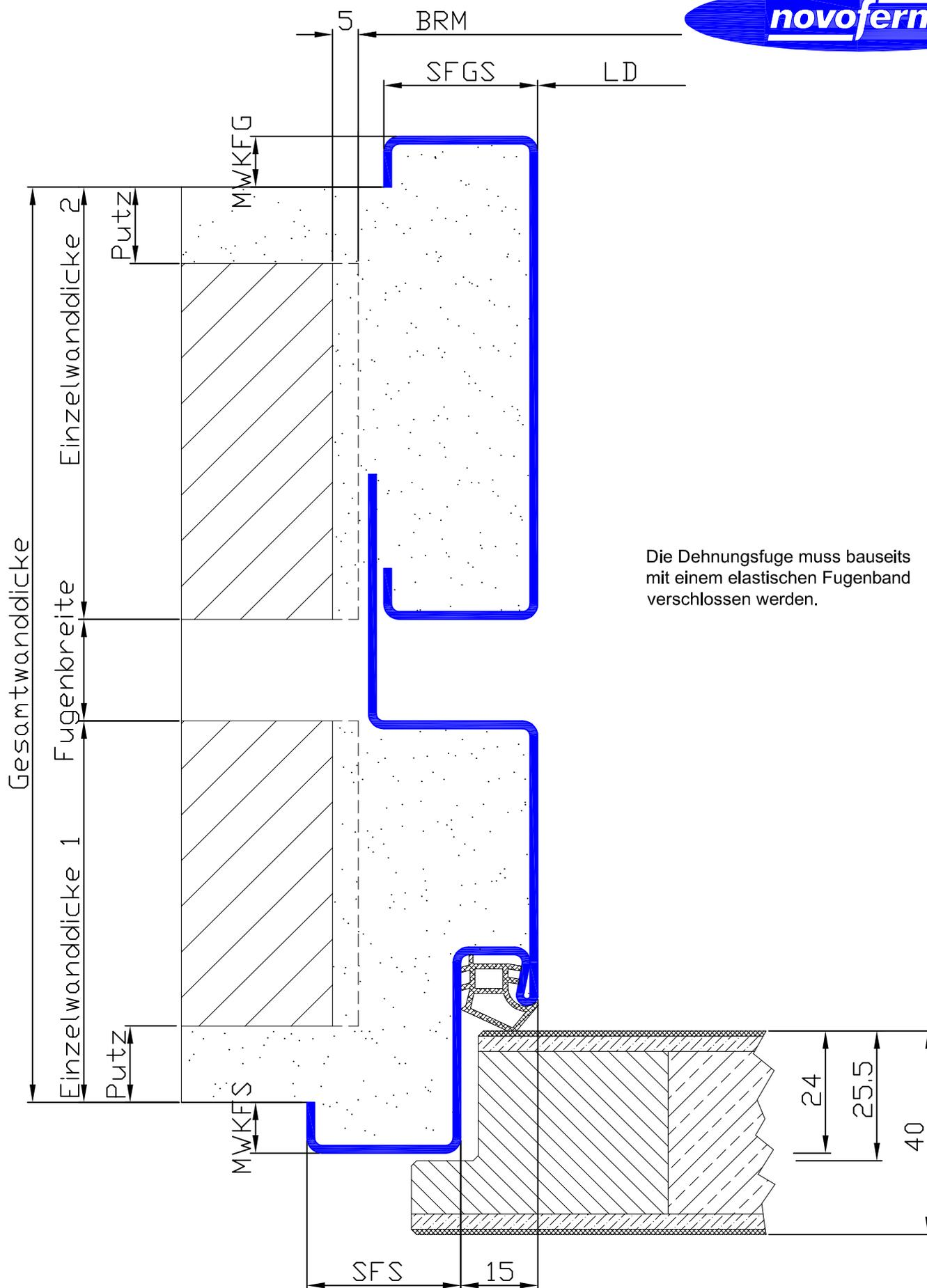
Die Dehnungsfuge muss bauseits mit einem elastischen Fugenband verschlossen werden.
