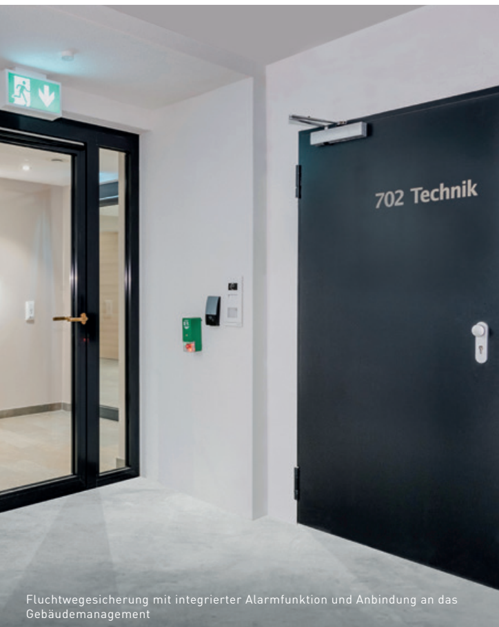
Rohrrahmentüren NovoFire® T30 (EI30) RS mit Seitenteil in F30-Verglasung, in sehr robuster Ausführung mit drei Türbändern für den Alltagsbetrieb innerhalb des Verwaltungstrakts
