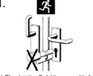
Bei Fluchttür-Schlössern dürfen keine Schließzylinder mit Knauf oder Drehknopf eingebaut werden.
