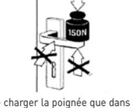
Ne charger la poignée que dans le sens de rotation normal. Dans le sens d'actionnement, max. 150 N doit être appliqué sur la poignée.
