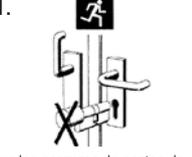
Pour les serrures de portes de secours, aucun cylindre de fermeture à bouton ne doit être monté.
