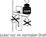
Drücker nur im normalen Drehsinn belasten. In Betätigungsrichtung dürfen auf den Drücker max. 150 N aufgebracht werden.
