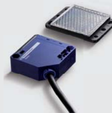
Extra 628 reflexiós fényzorompó • 24-240 V AC, 12-240 V DC, IP54 • hatótávolság: 5 m • csak jeladóként használható
