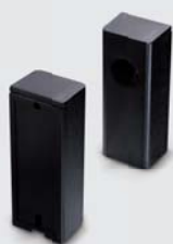
Extra 625 egyutas fényzorompó • 24 V DC, IP 54 • hatótávolság: 8 m • minden hajtásmodellhez alkalmas
