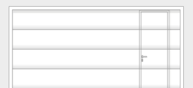
Aszimmetrikus elhelyezés középről balra vagy jobbra BRB 3501 - 5000 mm kapuszélességeknél
